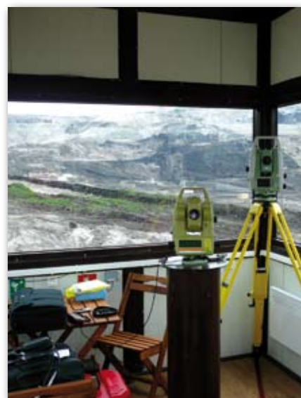
Stanowiska tachimetryczne wewnątrz kontenera pomiarowego systemu ciągłego monitoringu deformacji wyrobisk górniczych w odkrywcze KWB „Bełchatów”
