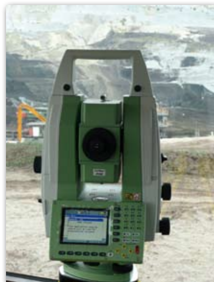
Precyzyjny tachimetr elektroniczny Leica TM30 w miejscu testowym
